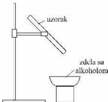
Slika 14. Uređaj za ispitivanja zapaljivosti plastične mase
