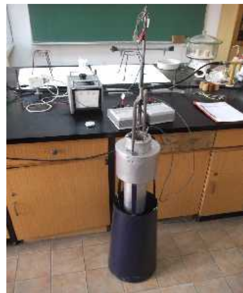
Slika 12. Peć za ispitivanje gorivosti materijala
