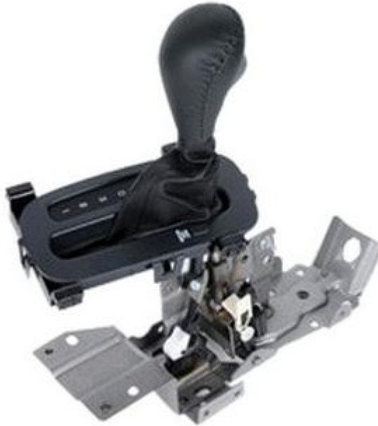
Слика 3: Изглед аутоматског бирача брзина и механизма
