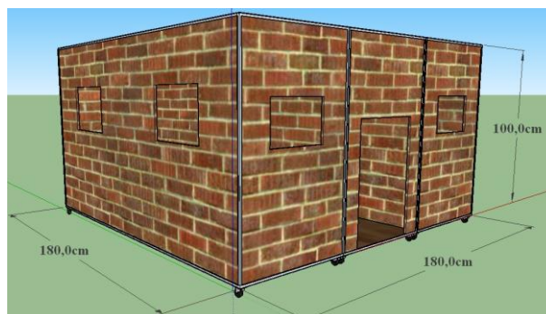
Слика 2. Идејно решење за челично-дрвена конструкција модела паметне куће
