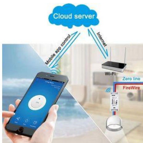
Слика 7. Принцип управљања Sonoff WiFi уређајем преко eWeLink апликације инсталиране на паметном телефону са Android оперативним системом [6]
