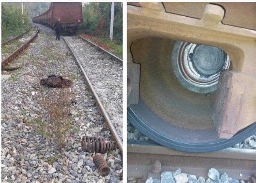
Slika 8 - Isklizniče vagona na pružnoj relaciji Čelinac-Ukrina
