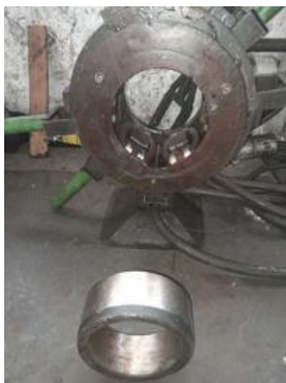
Slika 6 - Indukcioni apart za zagrijavanje prstena osovinskog ležaja
