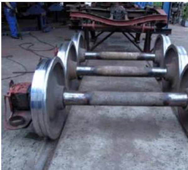
Slika 1- Osovinski sklop za teretne vagona
