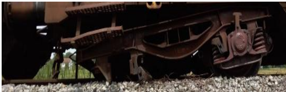
Slika 10 - Iskliznuće vagona iz šina uzrokovano lomom rukavca osovine
