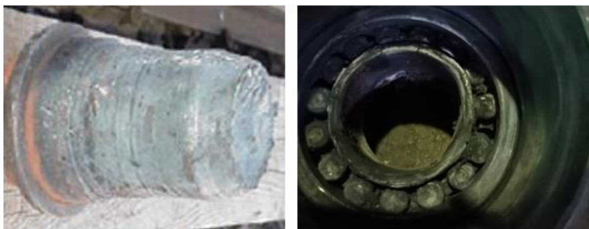
Slika 12 - Pohabanost prečnika rukavca osovine i unutrašnjeg prstena ležaja
