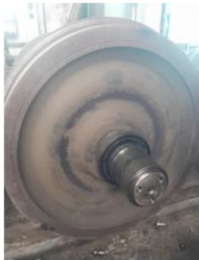
Slika 2 - Rukavac i osovinski sklop sa navučenim prstenom ležaja
