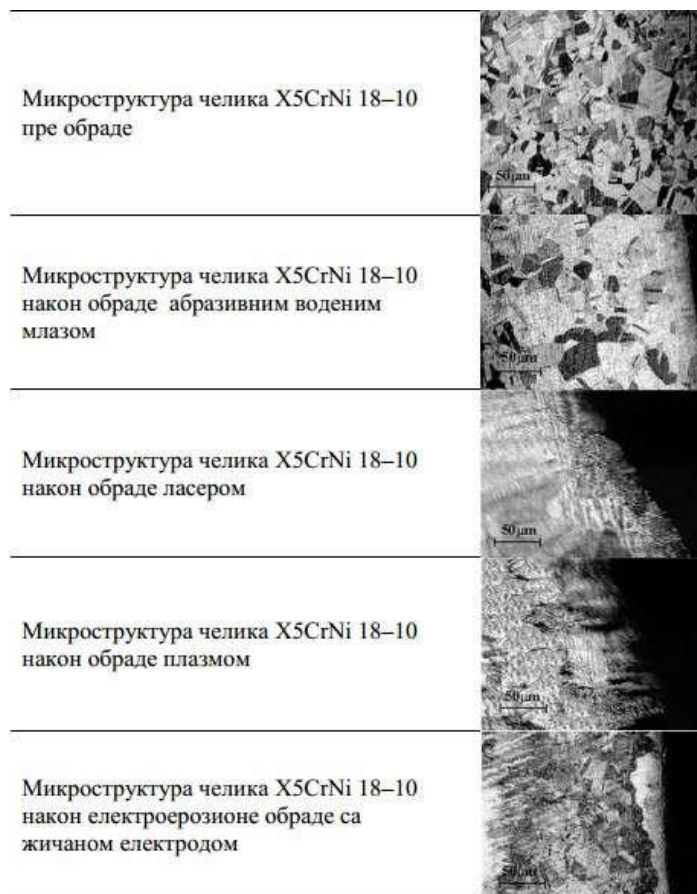
Slika 3 - Mikrostruktura čelika X5CrNi18-10 pre i nakon obrade abrazivnim vodenim mlazom, obrade laserom, plazmom i elektroerozijske obrade žičanom elektrodom 7
