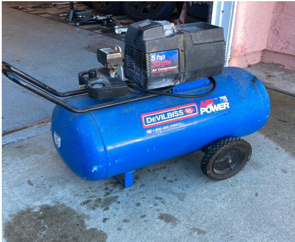
Слика 3.3.2 – Компресор са манометром за мерење притиска у гумама
