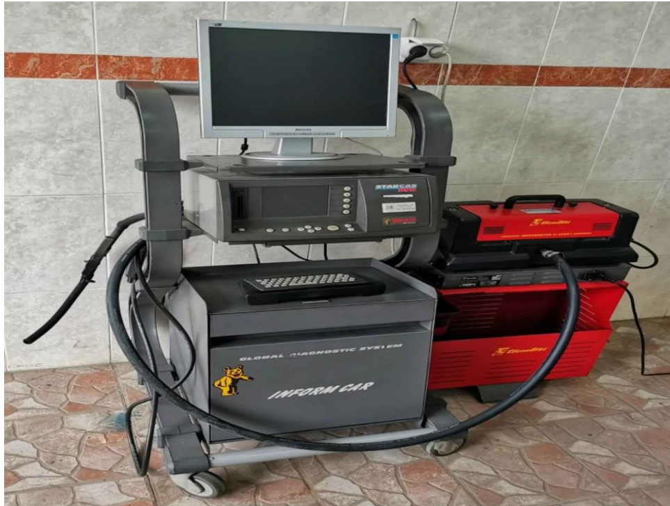
Слика 3.3.3 – Анализатор гасова и мерач издувних гасова код дизел мотора
