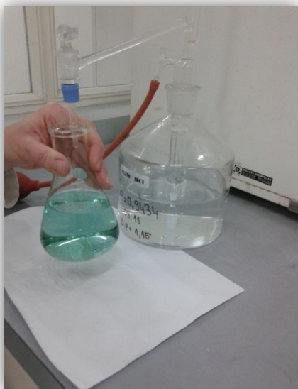
Слика 3.3.3: Титрација амонијум-метабората са 0,1 М HCl
