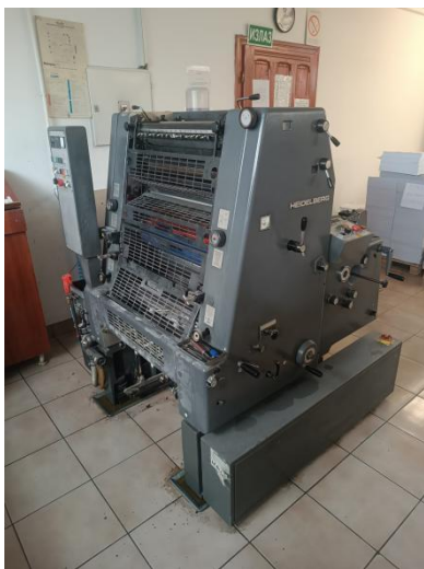
Слике 5. и 6. „Heidelberg GTO” једнобојна офсет машина за штампу која се налази у „Илијануму”
