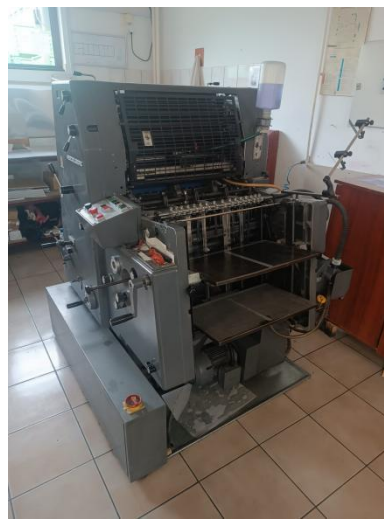
Слике 5. и 6. „Heidelberg GTO” једнобојна офсет машина за штампу која се налази у „Илијануму”
